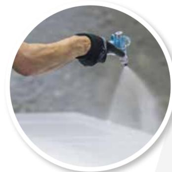
Per la verniciatura delle nostre porte abbiamo scelto **Sirca**, gruppo pionieristico nei campi dell'ecologia e della tutela della salute. Grazie all'avanzata tecnologia delle loro **vernici all'acqua**, siamo in grado di mantenere uno standard qualitativo elevato e durevole, utilizzando prodotti **rispettosi delle norme ambientali** e della **qualità dell'aria**, negli spazi domestici come in quelli in cui lavoriamo.
